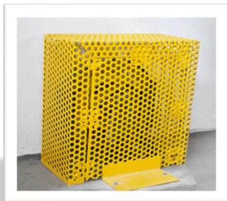
**8. Protetor de polia do limitador** – Protege as pessoas autorizadas ao acesso à casa de máquinas, evitando acidentes onde inadvertidamente, projetarem-se em componentes móveis (polias e cabos de aço) causando acidentes graves. **(Atende às exigências da Norma NBR NM207/1999 item 9.5.1, Norma de Segurança NR-12 e NR-18).**
